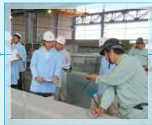
■外観・塗装検査
